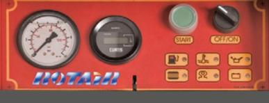
Plus besoin de démarrer la machine avec la sortie d'air ouverte (et plus aucun risque de l'oublier)
